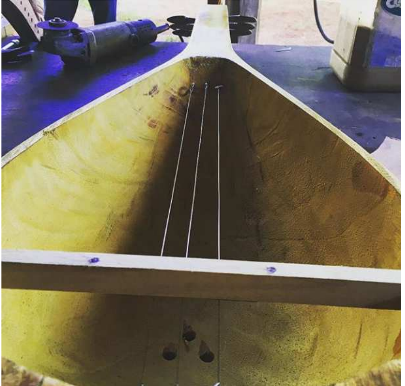
FIGURE 5.5 : une corde est tendue sous la table d'harmonie : cette technique est à présent étendue aux répliques de oud ( ici au Sabah).
