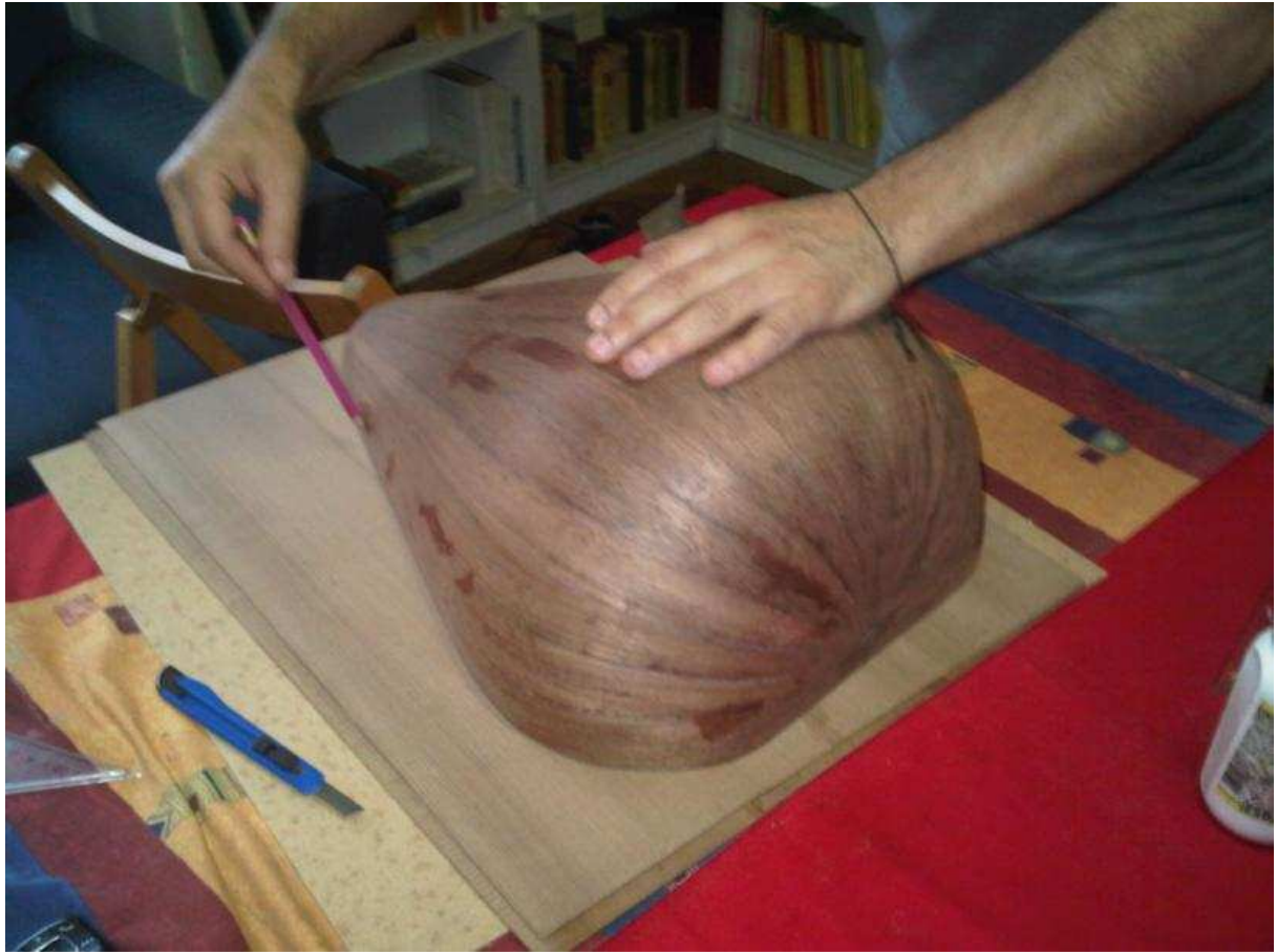
Shaping the soundboard ( Kumethra variant, maker Mofid Nehmeh, Lebanon)
