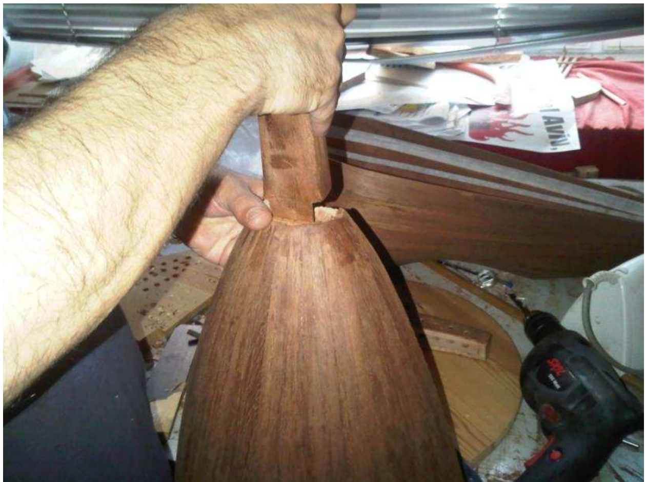
Adjusting the Neck dovetail. Maker Mofid NEHMEH, Lebanon.
