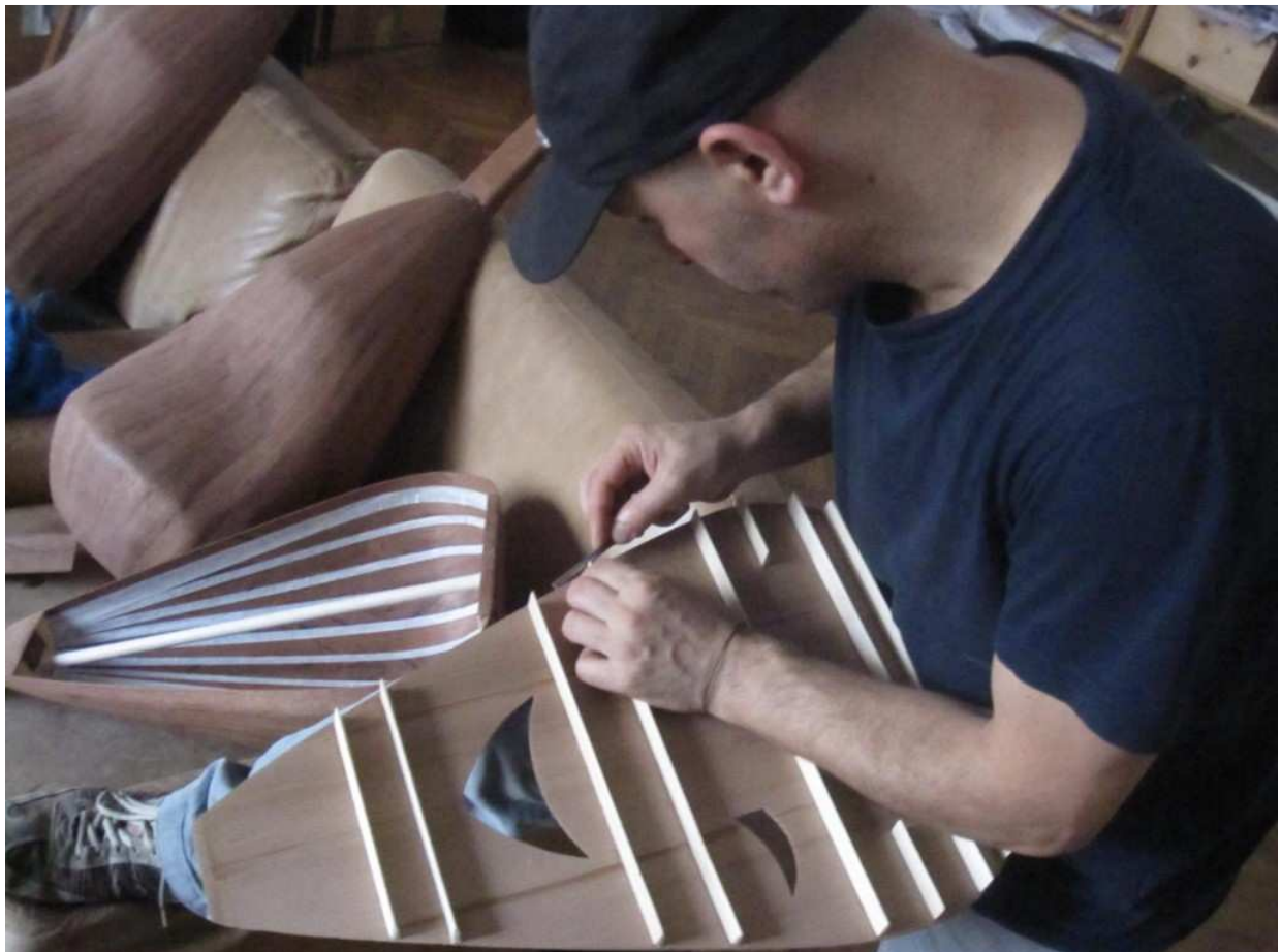
Strengthening a soundboard ( Kumethra variant, maker Mofid Nehmeh, Lebanon)
