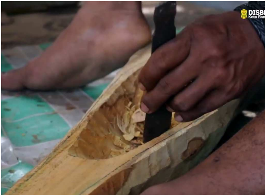
Hammering a gouge, maker HUSNI (Kota Banjarmasin)
