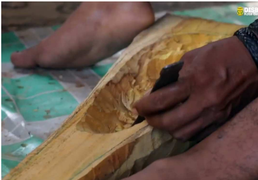
Hammering a gouge, maker HUSNI (Kota Banjarmasin)
