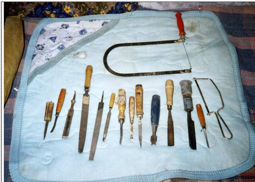
Figure 8 : Les outils du luthier : scies à détourer, limes à bois planes mashrama , limes rondes kura , ciseaux à bois minqar , poinçons divers. (photo Pierre d'HEROUILLE)
