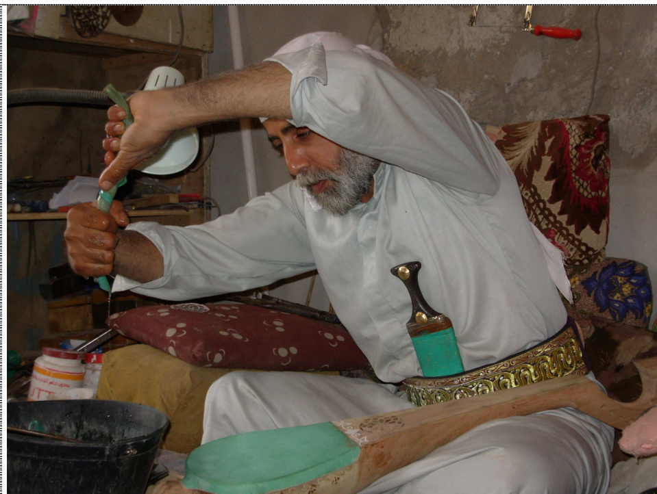
Figure 19 : essorage d'un échantillon de peau, après le bain de cuivre. Le luthier fait ici l'office du teinturier. (Photo Samir MOKRANI)
