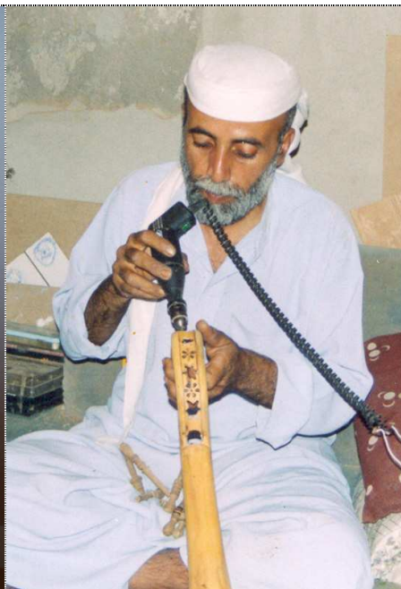
Figure 25 : décoration de la tête avec l'assistance de la scie électrique rotative. (Photo remise par le luthier)
